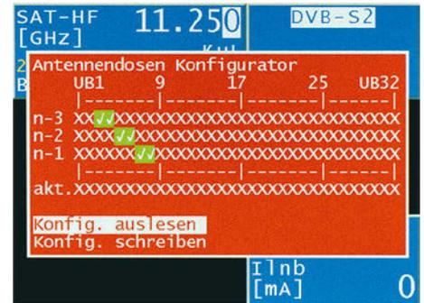
Konfigurationsmenü für programmierbare UNICABLE-/JESS-Antennendosen.
